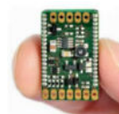
IFFDM6L Series [Serie] analog amplifier on PCB [analoger Leiterplatten-Messverstärker]
